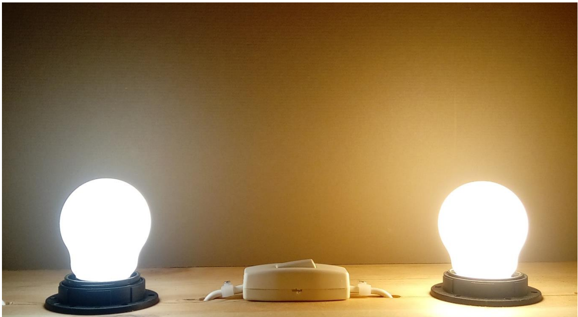
To lyspærer med identisk effekt og lysstrøm, men forskellige farvetemperaturer: 4000 K (t.v.) og 2700 K (t.h.)
